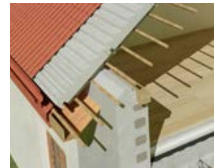
Schemat połączenia płyty dachowej Izodom ze ścianą.
